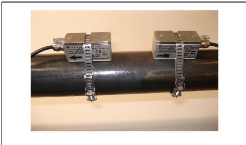
Рисунок 6: Установка датчика при помощи лент и зажимов
